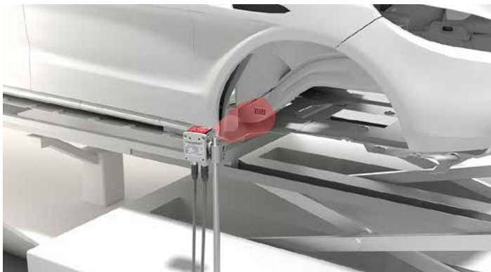
Los lectores de códigos basados en cámara que utilizan identCHAIN no solo proporcionan identificación individual de objetos, sino también información sobre el dispositivo y el estado para cada etapa de producción.
